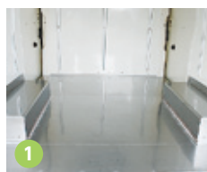
1 フロア材ステンレスフラットエアリブ (抗菌材使用)
